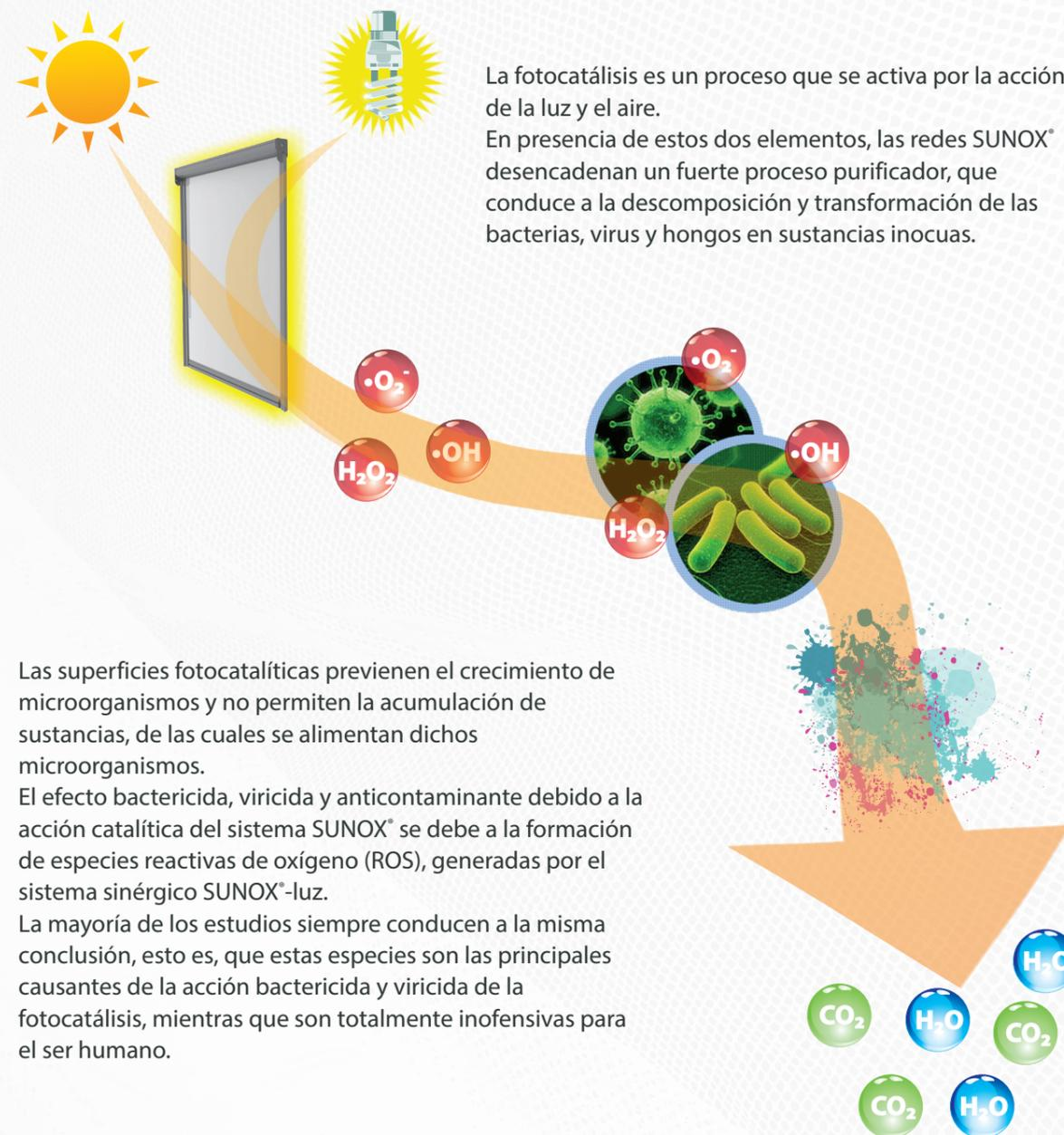
La fotocatalisis es un proceso que se activa por la acción de la luz y el aire. En presencia de estos dos elementos, las redes SUNOX® desencadenan un fuerte proceso purificador, que conduce a la descomposición y transformación de las bacterias, virus y hongos en sustancias inocuas.
